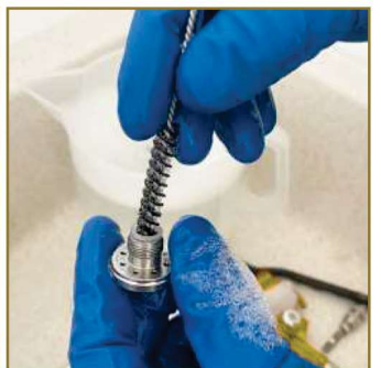
10 - Nettoyez avec les goupillons la buse de chaque côté.
