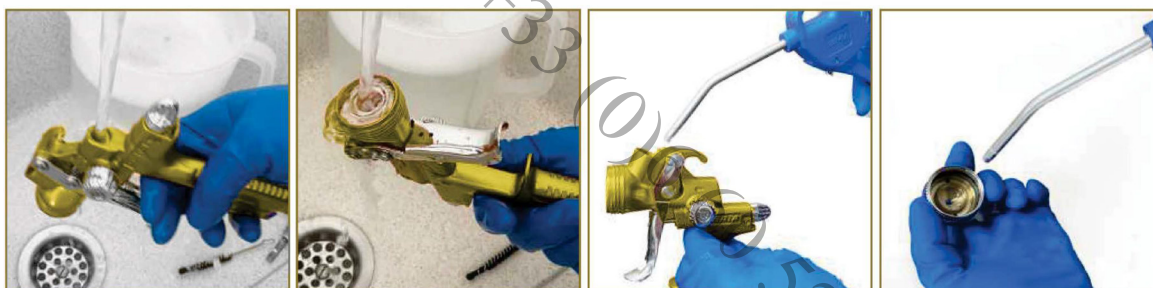
14 - Rincez à l'eau claire le corps du pistolet et le canal du produit.
