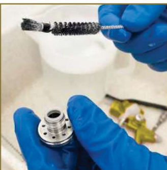
10 - Nettoyez avec les goupillons la buse de chaque côté.
