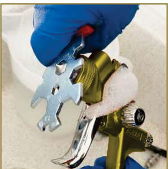
9 - Démontez la buse (voir étapes "Démontage du kit projecteur").
